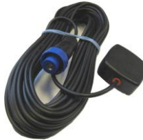
Fig. 44. External GPS antenna.
